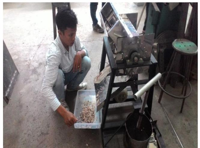
Gambar 4.3 Pengujian Mesin Pembuat Abon Ikan
