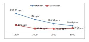
Berdasarkan dari grafik pengujian buang emisi gas hidrokarbon (HC) dapat dilihat buang hidrokarbon emisi gas terendah dengan menggunakan 180 kawat tembaga sebagai katalis pada saluran buang sepeda motor yamaha vega zr pada yaitu 39.66 ppm pada Rpm 2500 dan
