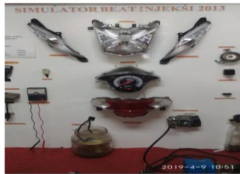
Gambar 1. Simulator sistem bahan bakar Programed Fuel injection (PGM FI) pada sepeda motor
