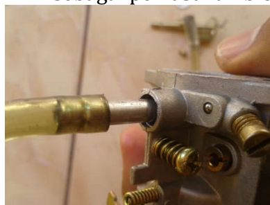
Gambar 3.2. Mengganti katup throttle dengan pipa 5mm
