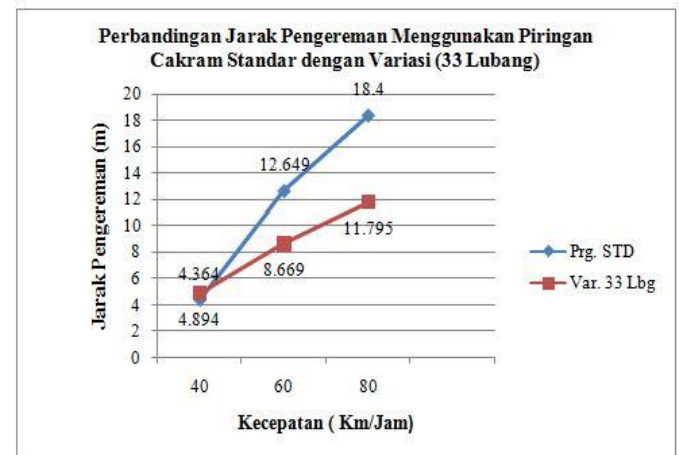
Gambar 3. Grafik perbandingan jarak pengereman menggunakan piringan cakram standar dengan variasi (33 lubang)
