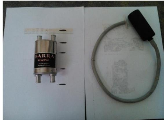
Gambar 1. Tabung Induksi Barra Racing dengan volume tabung 137,5 cc dan tabung induksi Gas Motor dengan volume tabung 50,03 cc.
