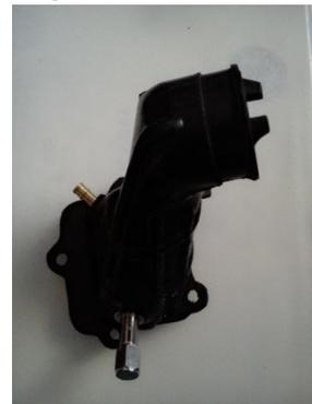
Gambar 2. Intakemanifold yang terpasang neppel
