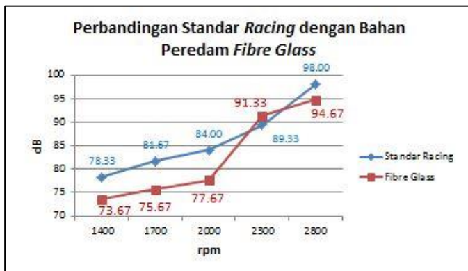
Gambar 9. Grafik perbandingan standar racing dengan bahan peredam fibre glass
