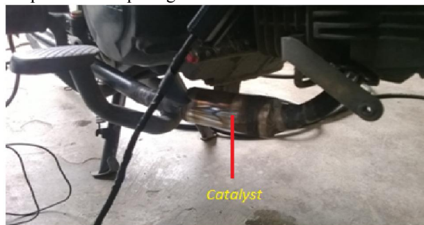
Gambar 1. Pemasangan Catalyst Pada Knalpot
