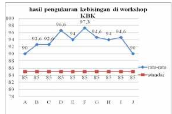
Gambar 1. Pengukuran pada ruang KBK
