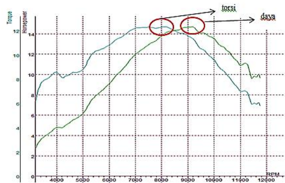
Gambar 7. Hasil pengujian menggunakan coil Racing (KTC)
