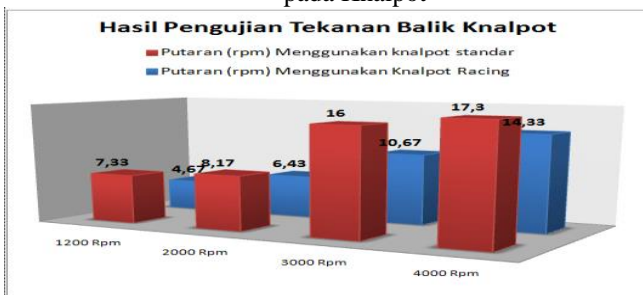
Gambar 5. Hasil Pengujian Tekanan Balik pada Knalpot
