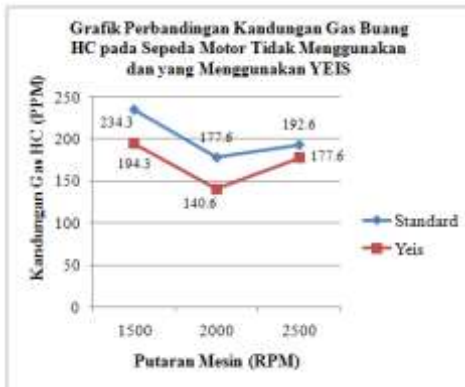
Gambar 5. Grafik Perbandingan kandungan gas buang HC pada Sepeda Motor tidak menggunakan YEIS dan yang menggunakan YEIS
