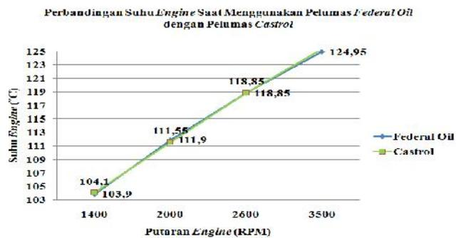
Gambar 11. Grafik pengujian suhu *engine* menggunakan pelumas Federal Oil dengan Castrol
