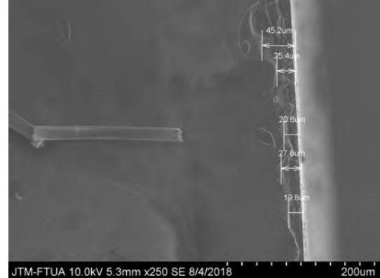
Gambar 8. Hasil pencitraan ketebalan sampel menggunakan SEM pada fraksi 30%
