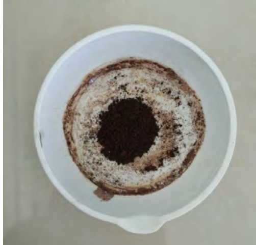
Gambar 4. Serbuk \text{NiFe}_2\text{O}_4 setelah di kalsinasi pada suhu 400^\circ\text{C} selama 2 jam
