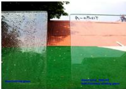
Gambar 1. Kaca spion, atas: tidak dilapisi lapisan nano self-cleaning, bawah: dilapisi lapisan nano self-cleaning, dan uji coba kaca jendela bangunan [5] .
