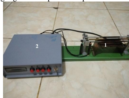
Gambar 7. Bentuk fisik set eksperimen muai panjang digital
