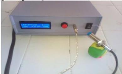
Gambar 7. Sistem Pengukuran dan Sensor *Proximity* induktif
