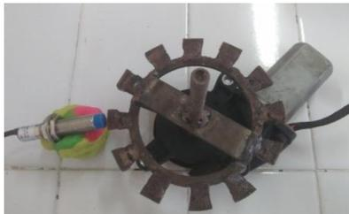
Gambar 8. Posisi Sensor *Proximity* dengan *Gear*
