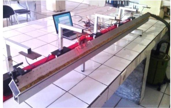
Gambar 12. Foto Hasil Desain Sistem Pengukuran Besaran Gerak Lurus Berbasis Personal Komputer Menggunakan Sensor Optocoupler
