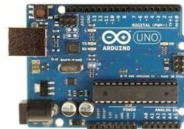
Gambar 3. Bentuk Fisik Papan Arduino<sup>[10]</sup>
