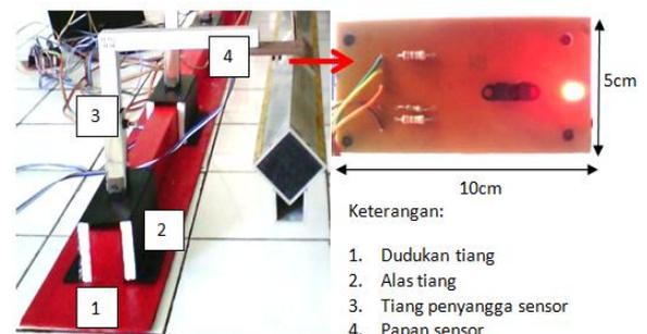
Gambar 13. Bentuk Tiang Penyangga Sensor dan Papan Sensor
