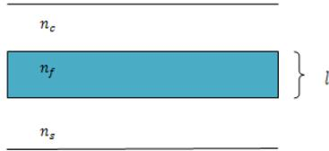
Gambar 5. Struktur Pandu Gelombang *Raised-strip* Searah Sumbu-x
