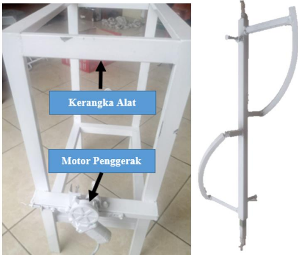
Gambar 3. Kerangka dan baling-baling pengaduk system takakura otomatis
