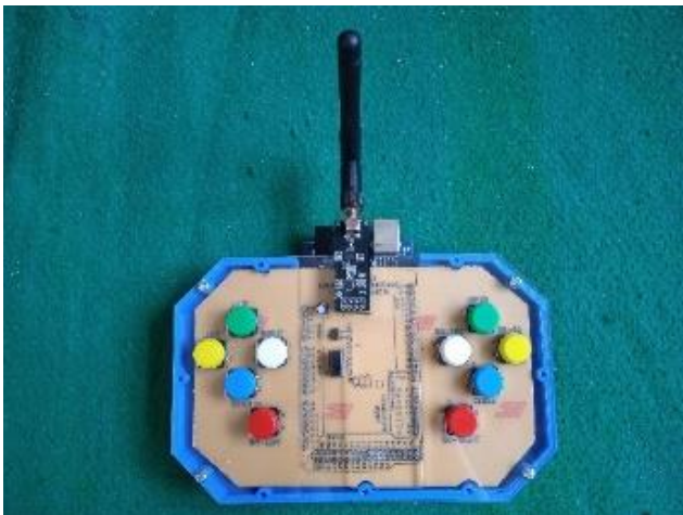
Gambar 7. Rangkaian kontroler joystick nRF24L01
