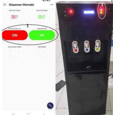
Gambar 31. Pengujian sistem kontrol menggunakan button Blynk
