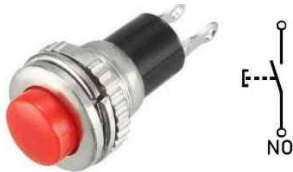
Gambar 3. Bentuk dan simbol push button
