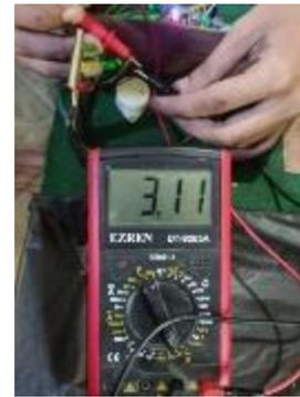
Gambar 25. Pengujian Buzzer
