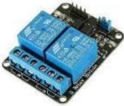
Gambar 6. Relay module
