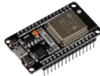
Gambar 1. NodeMCU ESP 32
