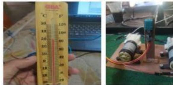
Gambar 22. Pengujian sensor suhu DHT11 dengan termometer
