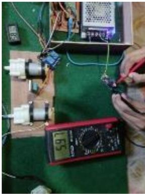
Gambar 23. Pengujian DC Step Down LM2596
