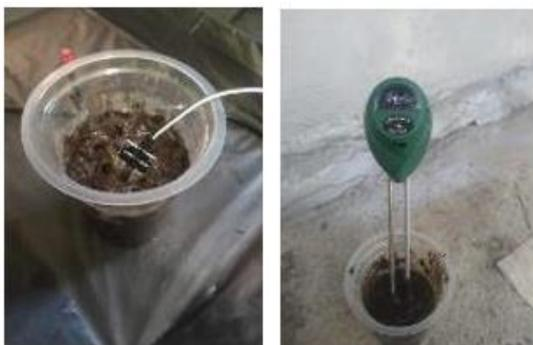
Gambar 21. Pengujian Sensor *Soil Moisture*
