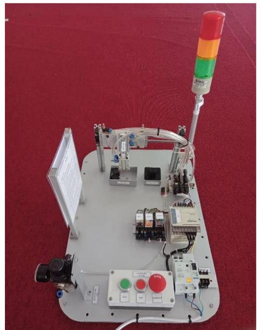
Gambar 9. Hasil pembuatan *prototype pick and Place* berbasis PLC.
