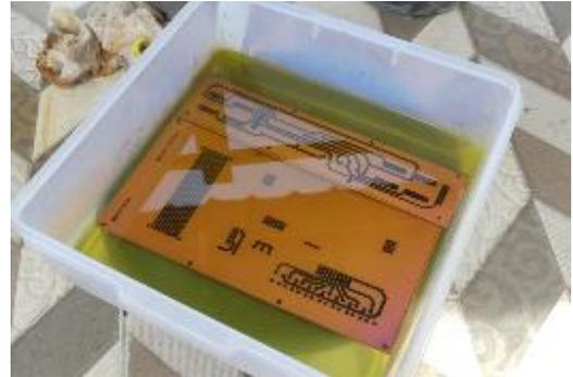
Gambar 4. Proses pelarutan blok trainer
