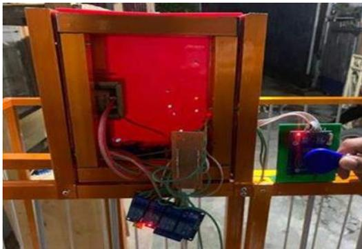
Gambar 18. Pengujian Sensor *RFID TAG* dengan *READER*
