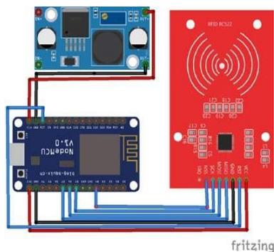
Gambar 10. Rangkaian *NodeMCU ESP32* dan Sensor *RFID*
