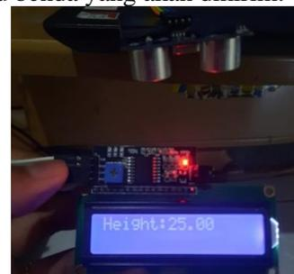
Gambar 18. Pengujian Sensor Ultrasonik HC-SR04
