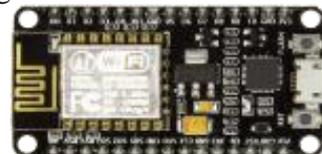
Gambar 1. NodeMCU ESP8266
