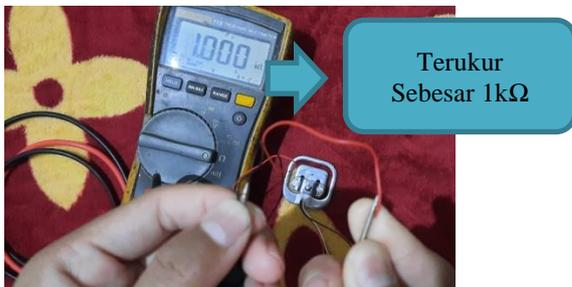
Gambar 20. Nilai Tahanan Kabel Hitam-Merah
