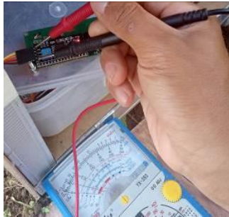
Gambar 21. Pengujian LCD( Liquid Crystal Display )
