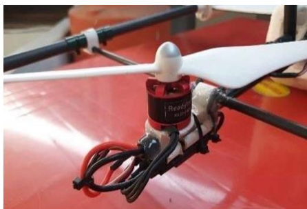
Gambar 18. Posisi rear motor pada bagian belakang UAV
