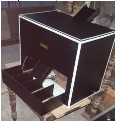
Gambar 16. Bentuk fisik Alat Deteksi Nominal Uang Kertas Tuna Netra Berbasis Arduino Uno
