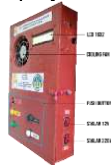
Gambar 19. Kotak kontrol sistem
