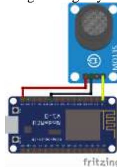
Gambar 13. Skema koneksi MQ-135 pada NodeMCU
