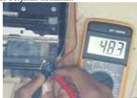
Gambar 17. Hasil pengukuran *limit switch* saat kondisi tidak membaca
