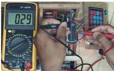
Gambar 15. Hasil pengukuran motor servo saat kondisi membentuk sudut 60 derajat
