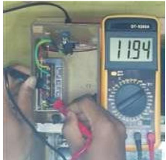
Gambar 10. Pengukuran pada *output power supply*.
