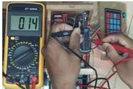
Gambar 16. Hasil pengukuran motor servo saat kondisi membentuk sudut 0 derajat
