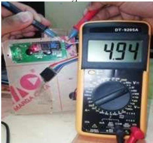
Gambar 13. Hasil pengukuran VCC LCD
