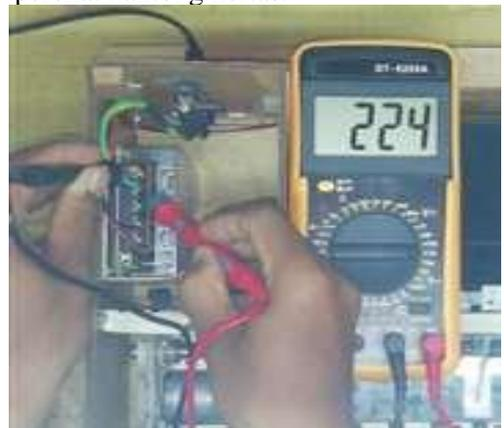
Gambar 12. Hasil pengukuran *input power supply*
