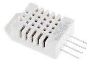
Gambar 2. Bentuk fisik sensor DHT22
