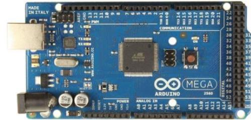
Gambar 1. Mikrokontroler Arduino Mega 2560.
