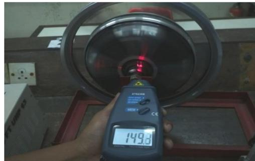
Gambar 10. Pengukuran RPM Dengan *Tachometer*
