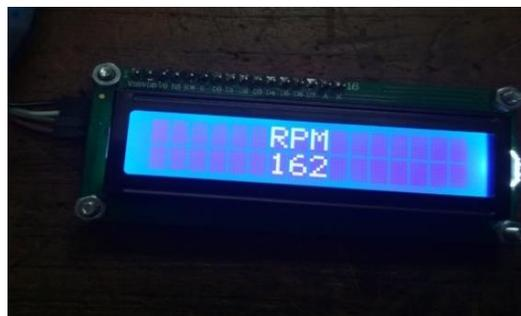
Gambar 11. Pengukuran RPM dengan sensor hall
