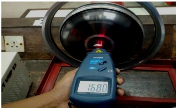
Gambar 12. Pengukuran RPM Dengan *Tachometer*
