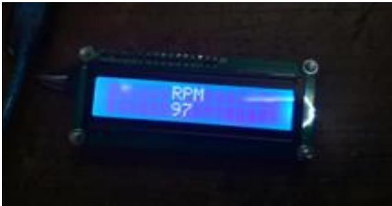
Gambar 7. Pengukuran RPM dengan sensor hall
