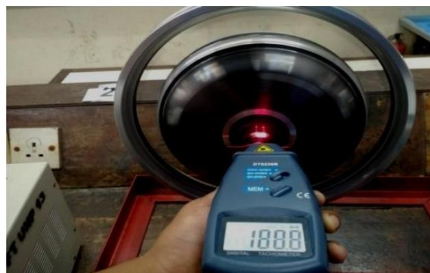
Gambar 16. Pengukuran RPM Dengan *Tachometer*
