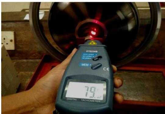
Gambar 8. Pengukuran RPM Dengan *Tachometer*
