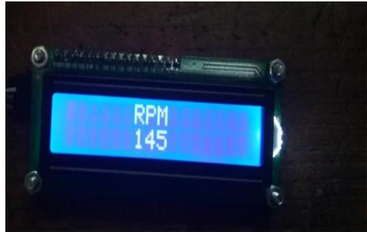
Gambar 9. Pengukuran RPM Dengan Sensor Hall
