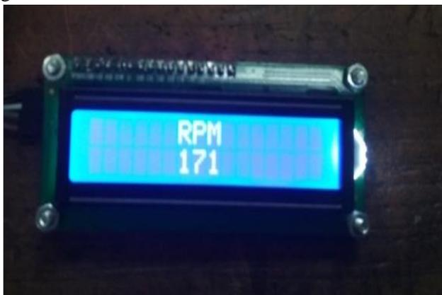
Gambar 13. Pengukuran RPM dengan sensor hall
