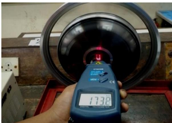
Gambar 14. Pengukuran RPM Dengan *Tachometer*
