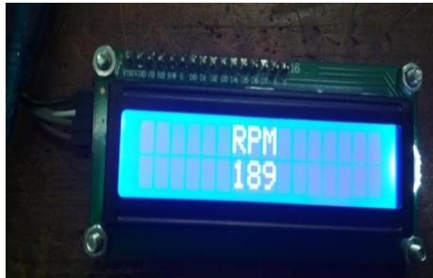
Gambar 15. Pengukuran RPM dengan sensor hall
