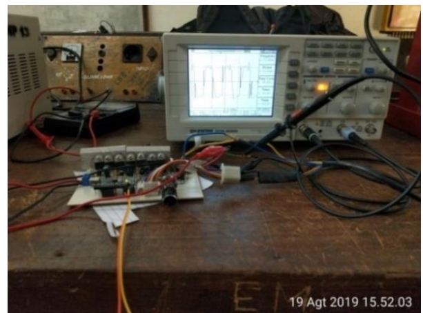
Gambar 20. Proses Pengukuran Gelombang Keluaran Inverter Pada Fasa A
