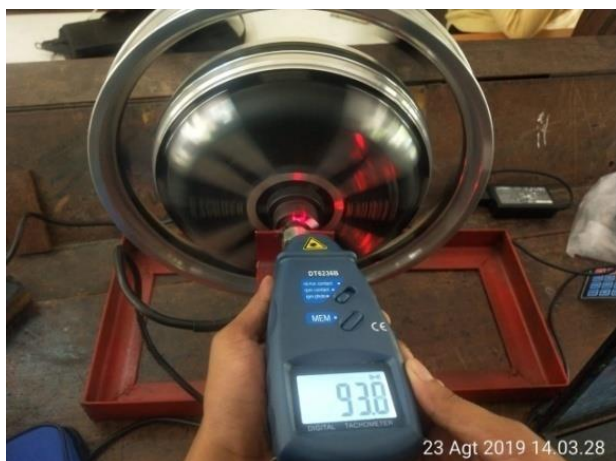
Gambar 22. Proses Pengukuran Kecepatan MASTS
