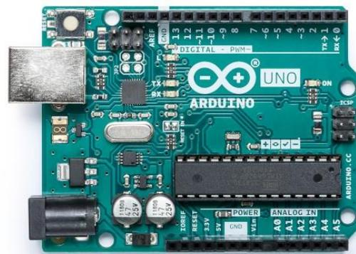
Gambar 3. Bentuk fisik Arduino UNO
