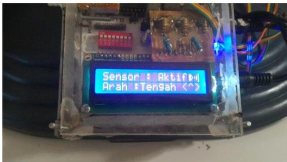
Gambar 12. Tampilan LCD 16x2 Saat Sensor PIR Menerima Sinyal di Tengah
