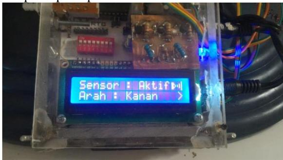
Gambar 11. Tampilan LCD 16x2 Saat Sensor PIR Menerima Sinyal di Sebelah Kanan
