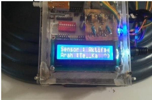
Gambar 14. Tampilan LCD 16x2 Saat Sensor PIR Menerima Sinyal di Tengah dan Kanan
