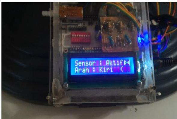
Gambar 13. Tampilan LCD 16x2 Saat Sensor PIR Menerima Sinyal di Sebelah Kiri
