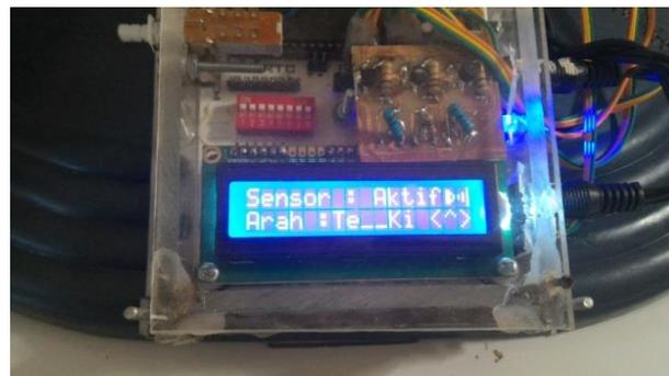
Gambar 15. Tampilan LCD 16x2 Saat Sensor PIR Menerima Sinyal di Tengah dan Kiri
