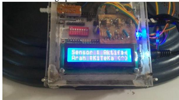
Gambar 16. Tampilan LCD 16x2 Saat Sensor PIR Menerima Sinyal di Tengah, Kanan dan Kiri
