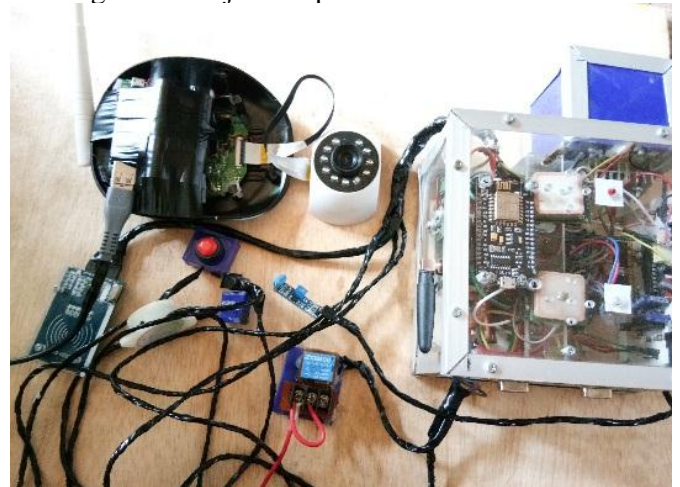
Gambar 3. Bentuk Fisik Alat Sebelum Terpasang Gambar 3 merupakan bentuk fisik alat sebelum terpasang ke body motor. Dudukan serta ukuran panjang kabel telah disesuaikan dengan kondisi body motor.
