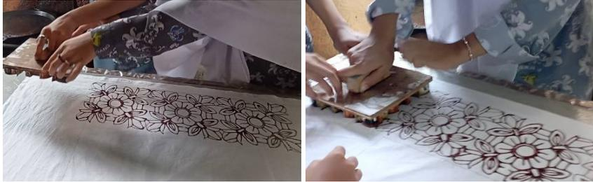
**Gambar 8.** Pengecapan Pada Permukaan Kain
