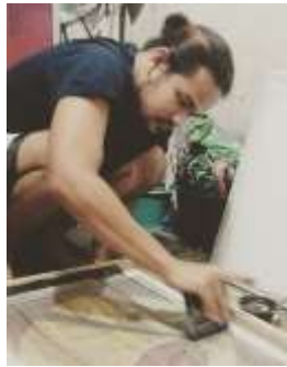
Gambar 2: Penggesutan tinta pada monil (Sumber: Adhatul Akbar, 2019)
