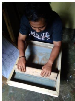
Gambar 3: Menyapu tinta menggunakan rakel (Sumber: Faizur Rahman, 2018)
