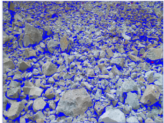
Gambar 5. Hasil Pengukuran Fragmentasi Usulan II Menggunakan Split Desktop 3.1
