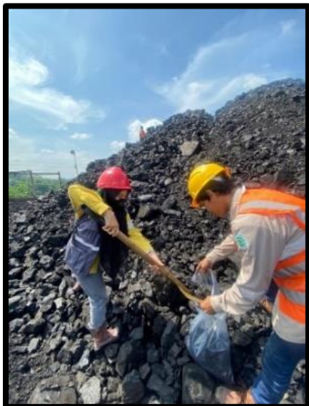
Gambar 4. Pengambilan sampel di stockpile
