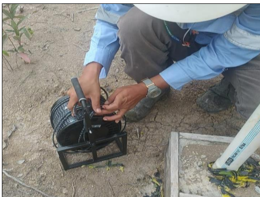
Gambar 2. Pengambilan Data Kondisi Muka Air Tanah Menggunakan Piezometer
