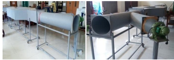
Gambar 4. Alat Simulasi Ventilasi Tambang Bawah Tanah
