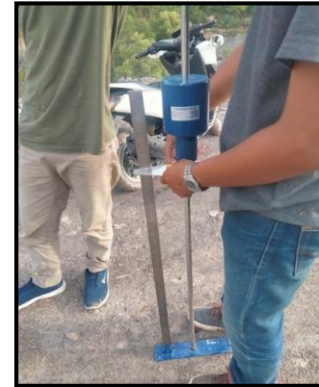
Gambar 12. Proses pengujian DCP 2
