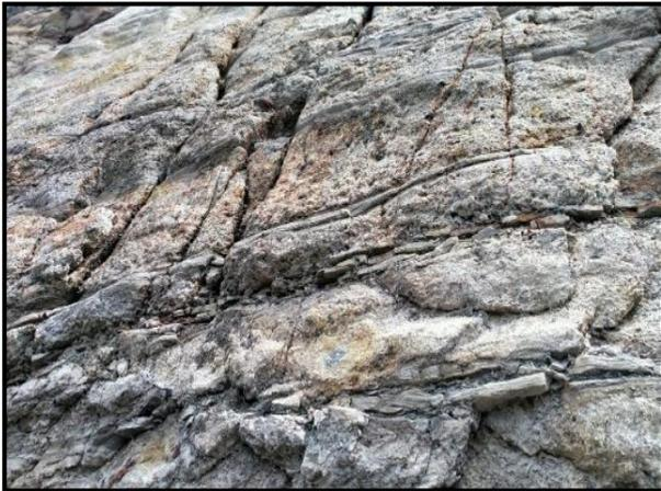
Gambar 2. Kekar pada permukaan lereng lubang Thc-04 CV.Tahiti Coal
