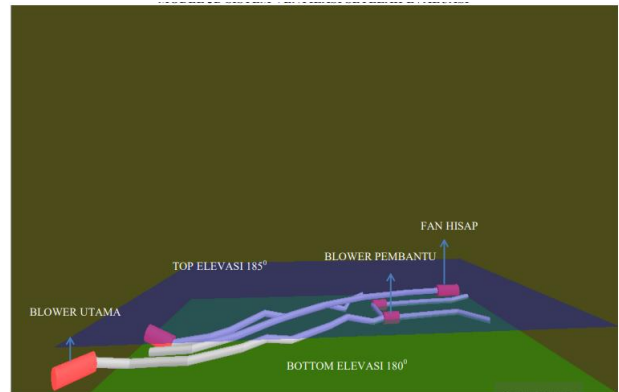
Gambar 9. Permodelan 3D Sistem Ventilasi Setelah Evaluasi
