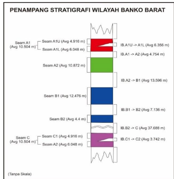
Sumber: Satuan Kerja Eksplorasi PT. Bukit Asam, Tbk Gambar 4. Kolom Stratigrafi Wilayah Banko Barat
