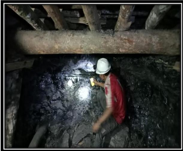
**Gambar 5.** Pengecekan Gas Pada Area Kerja
